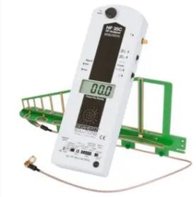
Nous ne pouvons pas voir le rayonnement électromagnétique, mais nous pouvons le détecter et le mesurer à l'aide d'un appareil de mesure. Nous faisons la distinction entre le rayonnement radioélectrique (wi-fi, Bluetooth, tours d'émission, mobiles) et champs de basse fréquence (par ex. lignes à haute tension et câbles électriques dans la maison).
