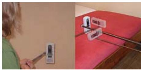
Handelsübliche EMF-Messgeräte verwenden einen leitfähigen Metallhalter (z.B. PM2 von Gigahertz Solutions), drei Messungen in den drei Raumachsen XYZ (gem. Abb.) und die vektorielle Addition<sup>1</sup> der Ergebnisse.
