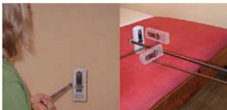
Tuttavia, per poter ottenere risultati di misurazione utilizzabili, questo metodo necessita di molta esperienza, è inoltre necessario usare un supporto che non conduce energia elettrica (come ad esempio il modello PM2 di Gigahertz Solutions), sono necessarie tre misurazioni lungo i tre assi principali dello spazio XYZ (si veda la foto) e occorre eseguire un'addizione vettoriale<sup>3</sup> dei risultati.
