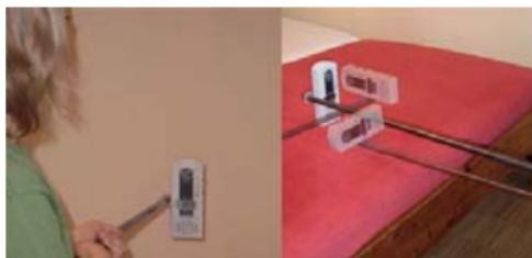
detendor dieléctrico (p. ej. el PM2 de Gigahertz Solutions), las mediciones efectuadas en todas las tres direcciones XYZ, y la adición vectorial de los resultados<sup>5</sup>.
