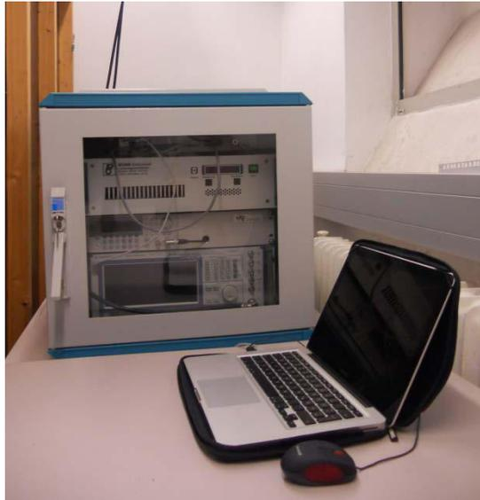
Abbildung 3.3: Aufbau der Signalgenerierungs- und Verstärkungseinheit, untergebracht in einem 19 Zoll Rack (Hintergrund) und Laptop Computer mit Steuer- und Aufzeichnungssoftware (Vordergrund), installiert am Institut für Umwelthygiene, Kinderspitalgasse, 1090 Wien.
