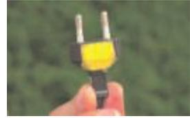
Zur **Kontrolle:** Leuchte ausschalten, einen Multitester (aktiver Prüfschraubendreher, z.B. MS-18/2) an das Kabel zwischen Schalter und Lampe halten. „Richtig“ eingesteckt darf der Multitester nicht leuchten. Noch besser: geschirmte Kabel nutzen. Erklär-Video von Dr. Moldan <http://t1p.de/z6xb>
