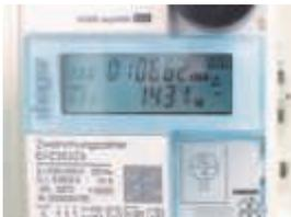
Seit 2017 sind in Deutschland **elektronische Stromzähler** vorgeschrieben. Diese werden nach und nach eingebaut. Für Haushalte mit einem Stromverbrauch größer 10.000 kWh im Jahr oder mit Betrieb eines Stromerzeugers, z.B. einer Fotovoltaikanlage mit mehr als 7 kWpeak besteht die Verpflichtung, zusätzlich ein sog. Kommunikationsmodul einbauen zu lassen. Ab 2020 liegt die Verbrauchsgrenze dafür bei 6.000 kWh/a.
